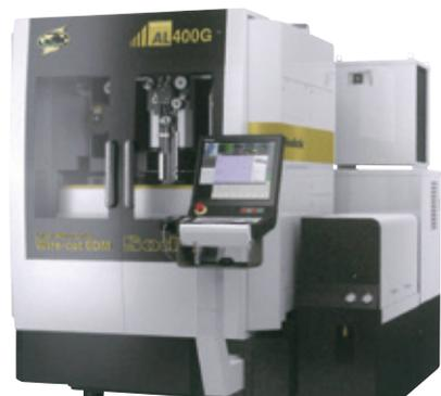
リニアモータ駆動 高速ワイヤカット放電加工機
